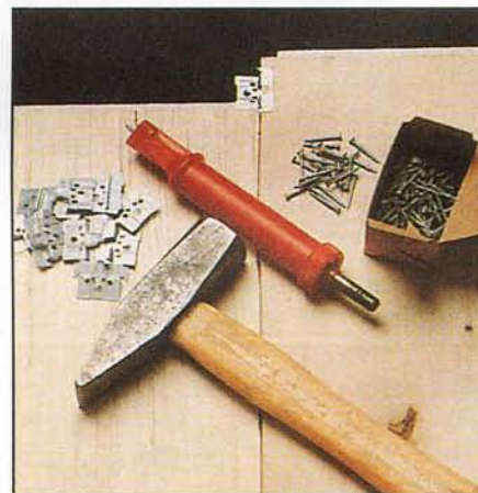
Инструменты и материалы для крепления панелей: молоток, магнитный добойник, стальные кляммеры и гвозди длиной 30 мм.
