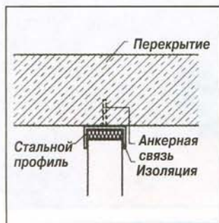
Соединение перегородки из пенобетонных блоков с монолитным перекрытием.
