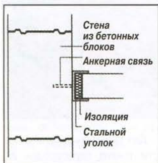
Скользящее соединение сооружаемой перегородки с несущей стеной.
